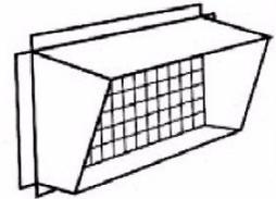
Accesorios fabricados en chapa galvanizada especialmente diseñados para las cajas de ventilación "MIX" y "MIX-T".
