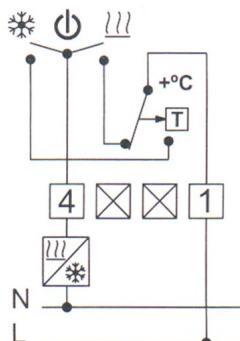
El termostato SONDER TA-3018 está especialmente diseñado para su uso tanto calefacción como en refrigeración.
