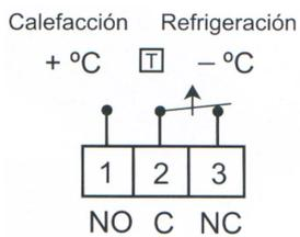
El termostato digital SONDER SIESTA-TA esta especialmente diseñado para su uso tanto calefacción como en refrigeración.
