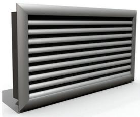
Las rejillas intumescentes Gz60 están fabricadas con un material intumescente (silicato sódico forrado de PVC) de protección contra el fuego que, bajo la influencia del calor (100°C), se transforma en espuma, obturando juntas y aperturas, oponiéndose así al paso de las llamas y, por tanto evitando la propagación del fuego.
