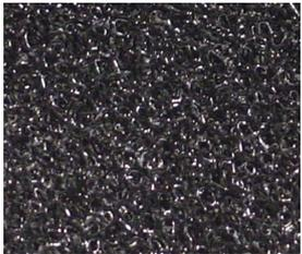
La espuma filtrante PPI-20 está fabricada en poliuretano y reticulada sobre una base de poliéster. Es una espuma de célula abierta que no provoca grandes pérdidas de carga. Cuanto más grande sea el valor de PPI (PPI es el nº de células abiertas), más capacidad de filtración.
