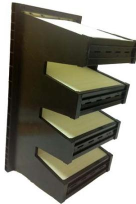
Los filtros compactos FRC son un tipo de filtros rígidos con una carcasa construida con poliestireno inyectado. Están fabricados en papel de fibra de vidrio micronizado de doble capa, plegados por el sistema minipleat, con separador termoplástico. Son ignífugos y resistentes a la humedad.
