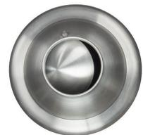
Las toberas de largo alcance de la serie DLM-TR y DLR-TR incorporan un elemento térmico que se dilata o contrae al variar la temperatura, regulando de manera automática un mecanismo que provoca una reorientación de la salida del aire con una inclinación máxima de  $\pm 30^\circ$ .
