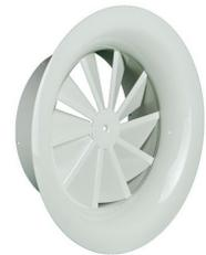
Difusor rotacional de aletas fijas y curvilíneas. Las ranuras del difusor han sido diseñadas para asegurar una impulsión rotacional con alta inducción, para obtener reducidas velocidades de aire y un moderado gradiente de temperatura en la zona de habitabilidad, así como un bajo nivel sonoro.
