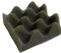
En forma perfilada o piramidal, son paneles fonoabsorbentes fabricados de poliuretano en base poliéter, con una elevada absorción en las zonas de altas frecuencias. Con su particular forma triplican la superficie de absorción, cubriendo una amplia zona.
